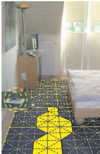
Intelligenter Teppich: Eingebaute Sensoren registrieren, wenn der Bewohner stürzt und senden – wenn dieser nicht mehr aufsteht – Signale aus, damit schnell Hilfe kommt.
